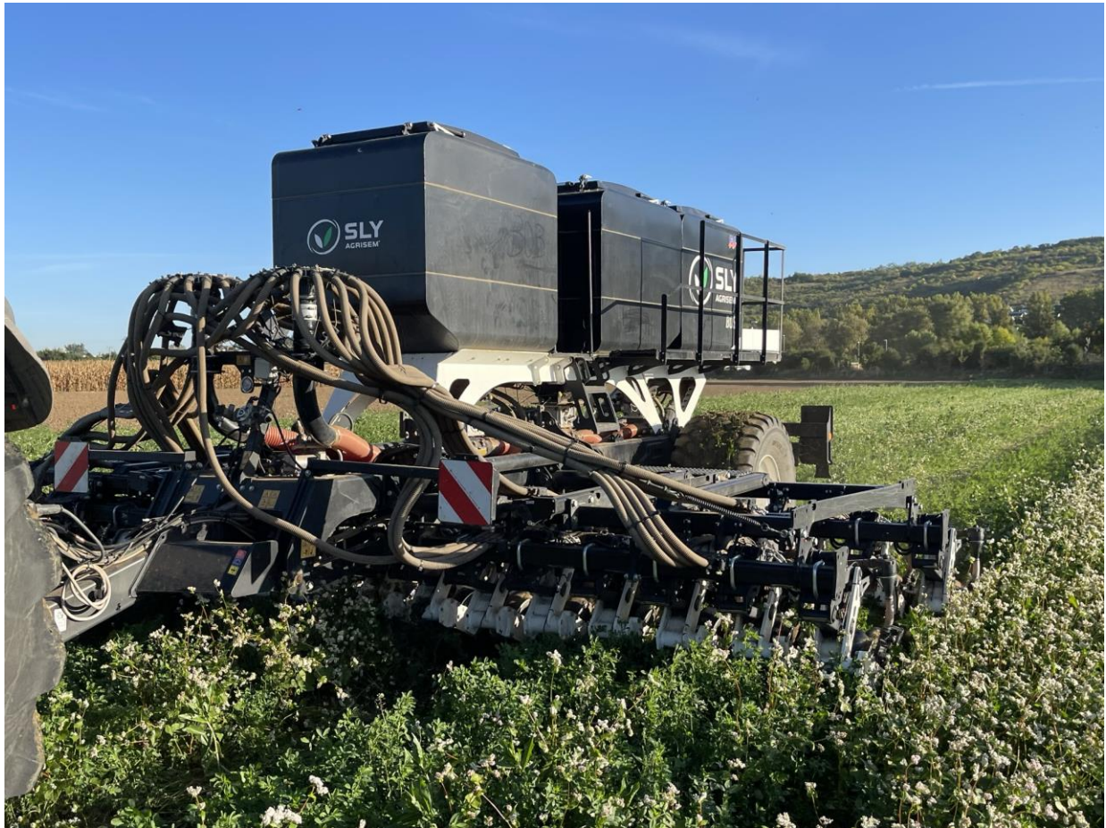
Foto 9: Secí stroj SLY Agrisem Boss – setí obilniny do porostu meziploidy (R. Mátl, 2023)
